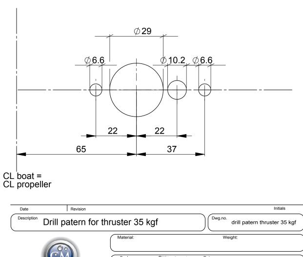
Scale: 1:1 Proj.: 13-09-2010 Drawn: D.C. Dim. in: mm Checked: Size: A4 Sheet: of: Manoeuvring
